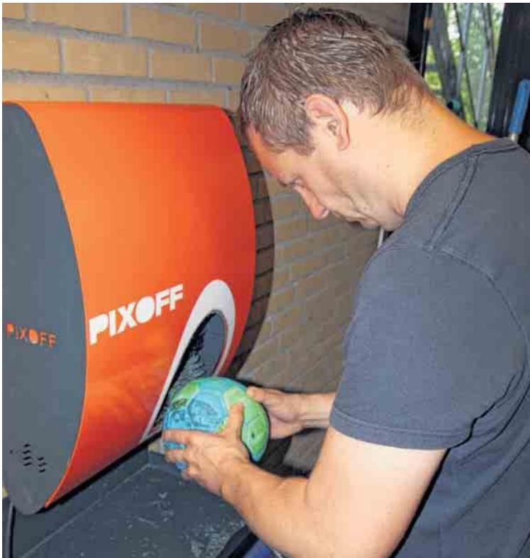
So putzt auch der Mann gerne: Mirko Lenz demonstriert die Ballputzmaschine. Auf der Oberseite ist das Sportgerät bereits sauber. Seitlich sind noch die Verschmutzungen durch Harz zu sehen.
